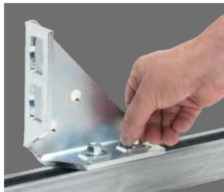
Verbinde durchführen und vormontieren durch Drehen des Verbinders um 90° – gegebenenfalls durch leichtes Drücken nachjustieren.
