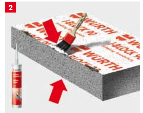
2 Nachbeschichten der Fehlstellen und Schnittkanten mit Ablationsbeschichtung beidseitig
