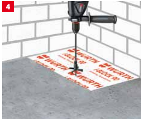
4 Einfaches Bohren der Durchführungen, z.B. mit Leichtbetonfräser, Zylindersäge, Bohrkronen, Säbelsäge
