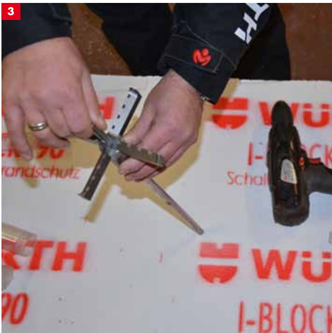
Zentrierspitze zum fixieren des Leichtbetonfräskopfes einschrauben.
