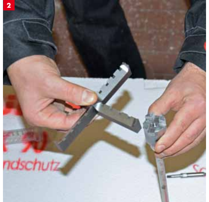
Aufstecken des neuen Leichtbetonfräskopfes
