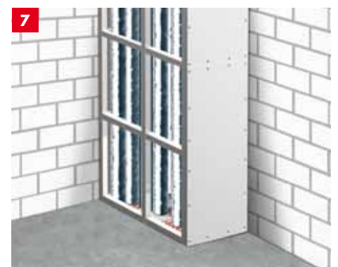
7 Verkleiden der Schachtwand. Fertig!
