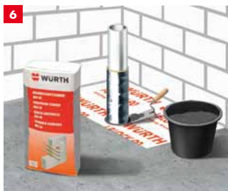
6 Verfüllen des Ringspalt mit Mörtel der Mörtelklasse MG III
